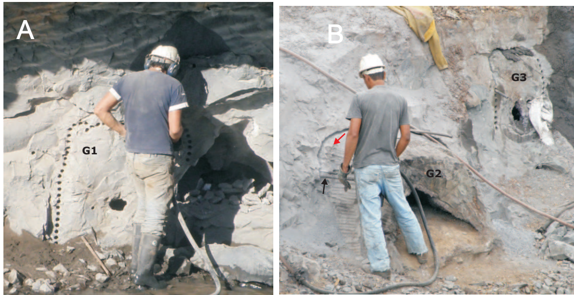
Figura 7.-3.8-A : Fase inicial en la extracción de geodas (G1, G2 y G3) con cara frontal libre. En esta primera fase, se corta/libera las caras laterales y superior a través de la ejecución de una gran cantidad de perforaciones. En la Foto B se observa 2 etapas de esta fase inicial : 1. Geoda aun unida al frente a través de un "tabique" entre perforaciones (G3). 2. Geoda parcialmente separada del frente, luego de ejecutar un segundo corte que rompe los " tabiques" (G2 - flecha roja). Para ello se usa una barremina que sirve como guía del segundo corte (G2 - flecha negra). También se observa los orificios en el frente de las geodas por donde se realizo la evaluación de calidad y tamaño/forma de la misma.
