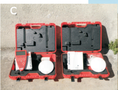
Figura 2.-2.5 : Equipos/métodos utilizados para la ejecución del relevamiento. Foto A: Magnetómetro portátil marca Geometrics. Foto B : ejecución de la malla geofísica. Foto C : Equipo GPS de alta precisión Leica/SR510. Foto D : Posicionamiento de puntos con GPS por el método cinemático para la realización de la malla geofísica y topografía. Foto E : Brújula minera colgante y eclímetro para el relevamiento de túneles.
